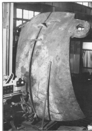
Рис. 1. Лепестки днища двухслойной стали 12ХМ + 0Х18Н10Т, подготовленные к ЭШС проволочным электродом
